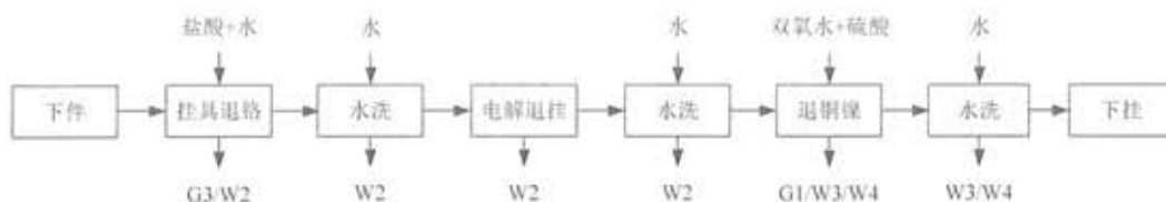
图 5.4-6 退镀生产线工艺流程及产污环节示意图
